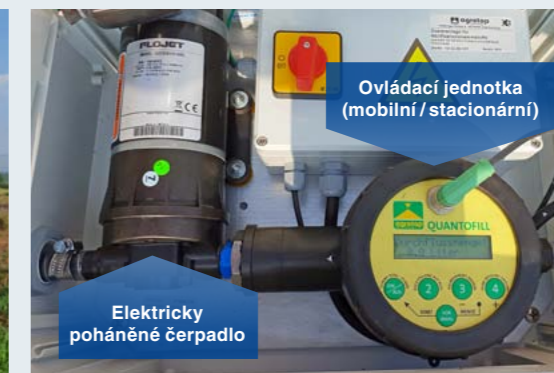
Elektricky poháněné čerpadlo a ovládací jednotka
