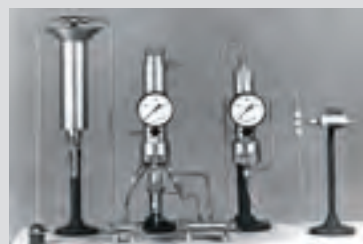
Pokusná aparatura Malé zařízení, velký účinek: aparatura Fritze Habera (zde vyobrazená replika) položila v malém měřítku základy syntézy amoniaku ve společnosti BASF.
