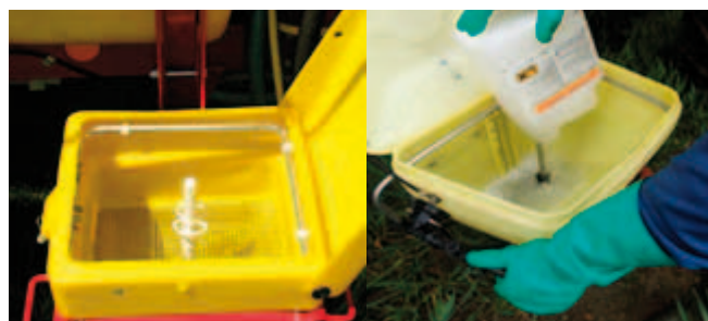
Nádrž postřikovače a proces vyplachování obalu od přípravku
